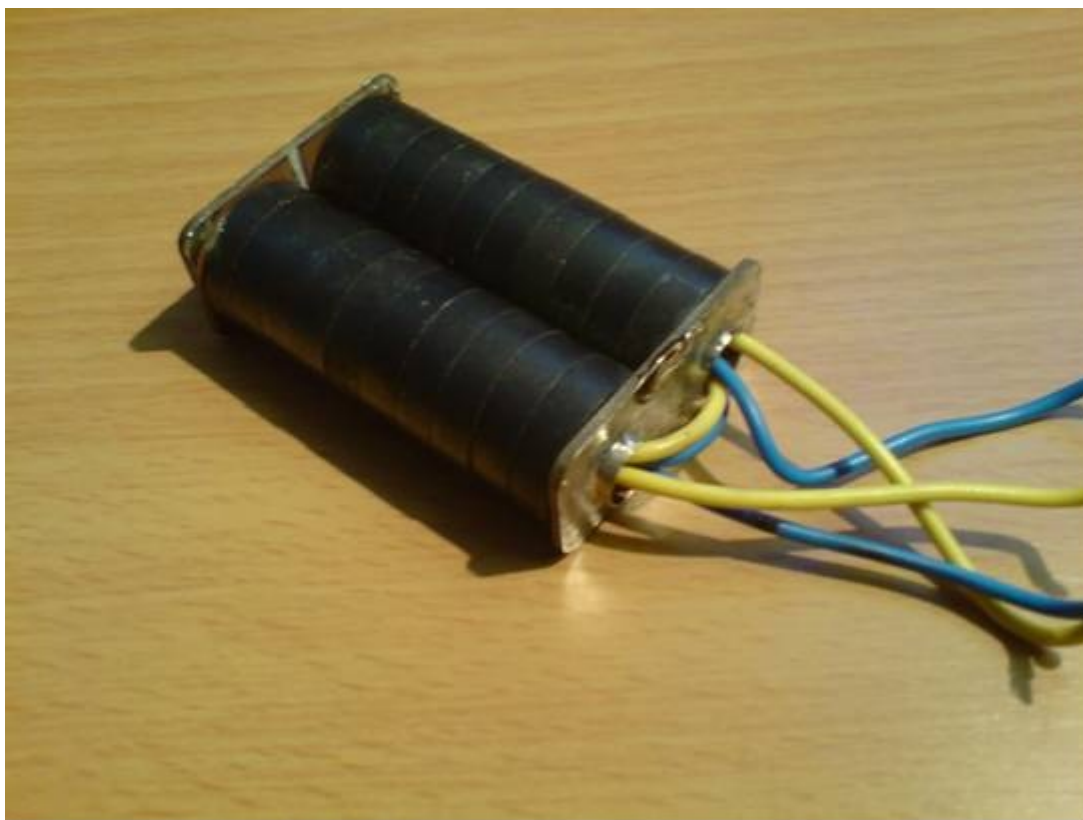
Рис 5. Выходной ШПТЛ конструкции «бинокль».
